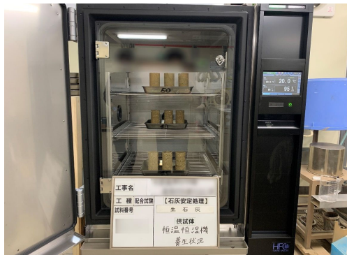
恒温恒湿器を使用した供試体の養生
